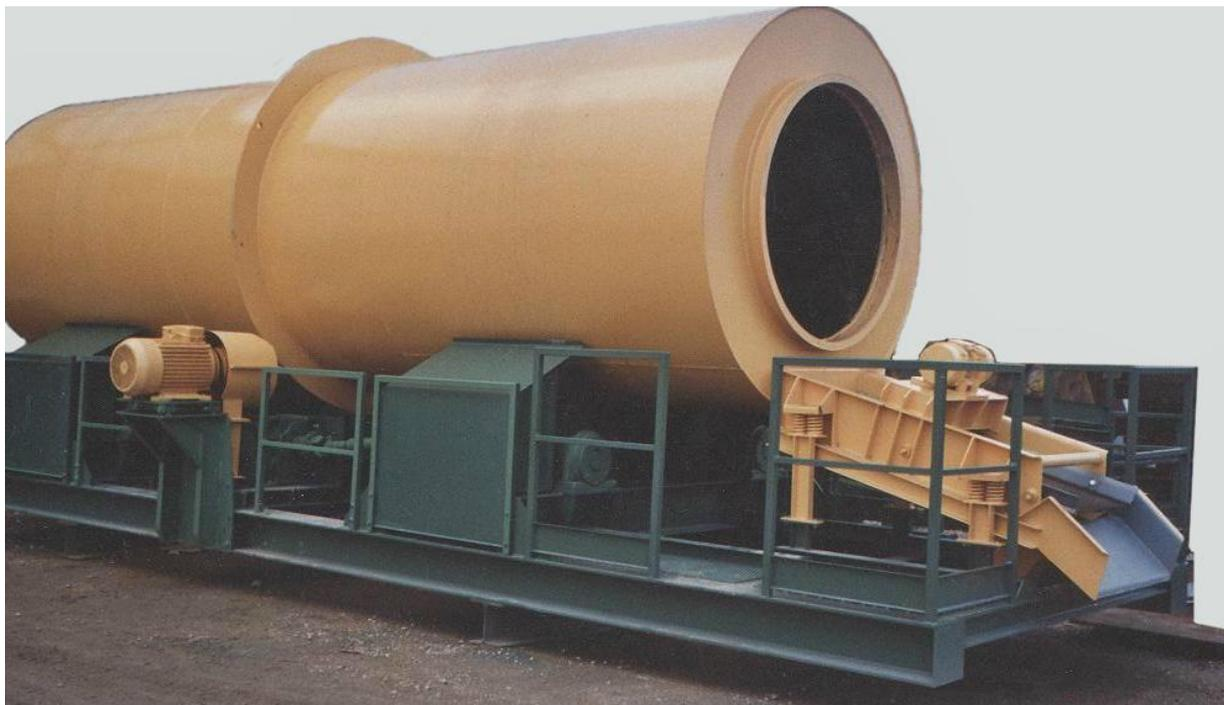
Le lavatrici sfangatrici a botte realizzano il lavaggio di materiali inerti, quali quelli di origine alluvionale, che presentano impurità tenaci come argilla e fango. Attraverso un efficiente sistema di pale e getti d'acqua il materiale trattato viene disgregato e lavato separando la parte nobile dalle impurità.
