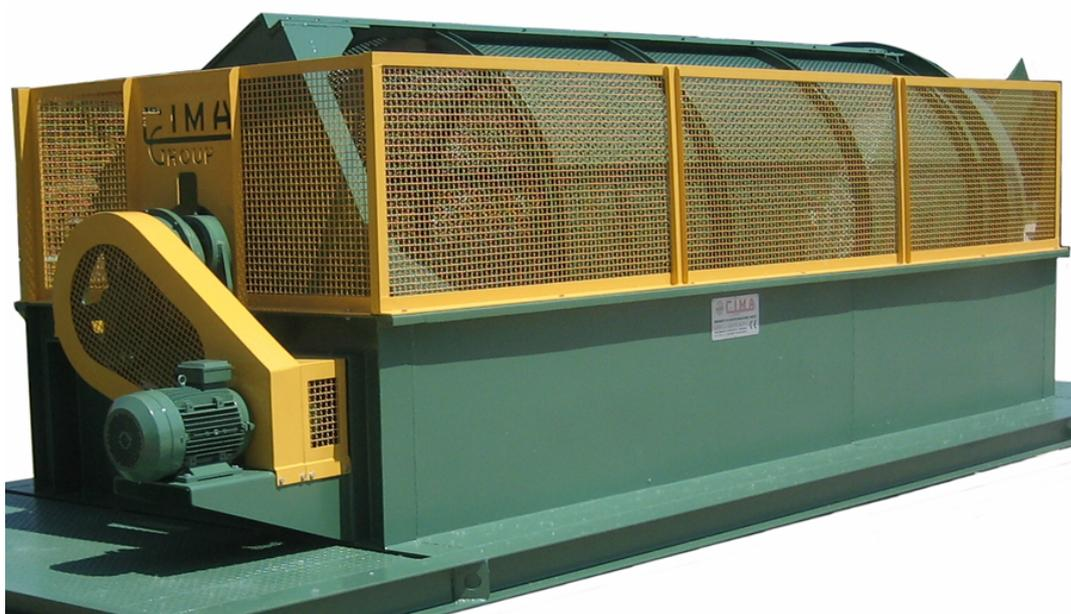
I Vagli Rotanti sono impiegati per la selezione di materiali di diversa granulometria. Sono indicati sia per la vagliatura di materiali inerti lapidei che di materiali da riciclaggio o da smaltimento ( rottami, carte e legnami, RSU).
