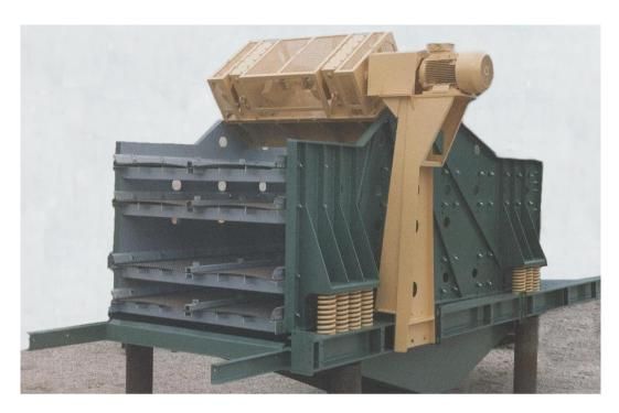
I vagli vibranti piani CIMA Engineering sono disponibili in più versioni per soddisfare tutte le esigenze di vagliatura. Il movimento si ottiene mediante oscillatori meccanici azionati da un motore elettrico. L'ampiezza di oscillazione è regolabile agendo sui masselli degli oscillatori. La frequenza è modificabile montando un apposito inverter.
