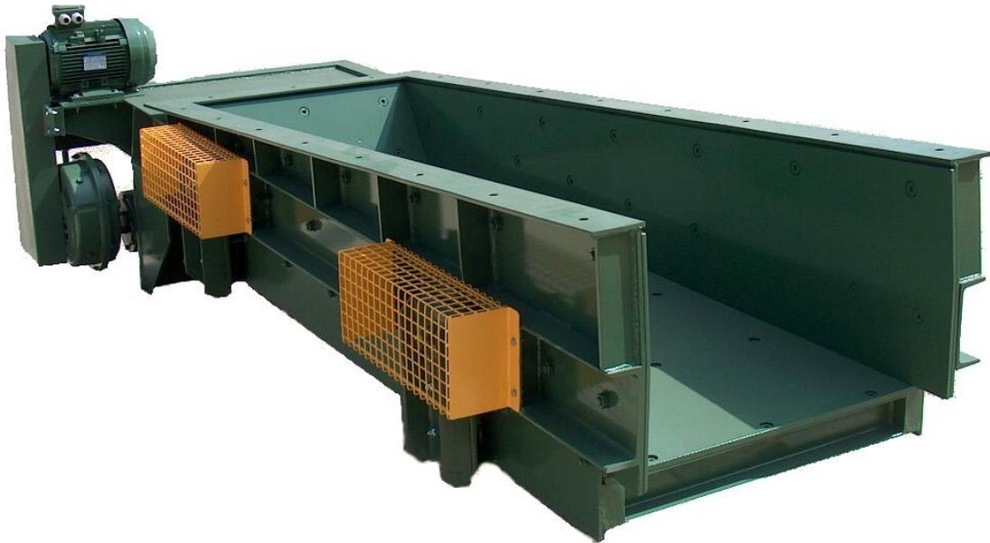
Queste macchine vengono utilizzate nell'alimentazione di materiale di grossa pezzatura ai frantumatori primari. Sono composte da un carrello che, azionato da un meccanismo biella-manovella, si muove avanti e indietro provocando l'alimentazione del materiale, la quale si può regolare modificando la corsa.
